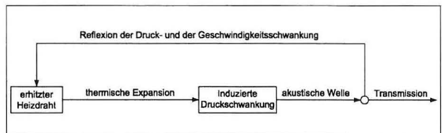
Abb. 8 Prinzipielle Darstellung der Rückkopplung einer thermoakustischen Instabilität
