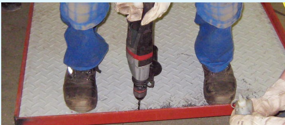
Hand-Arm-Vibrationen bei einer beidhändigen Bohrtätigkeit mit einer Handbohrmaschine, Verlauf der Beschleunigung über die Zeit
