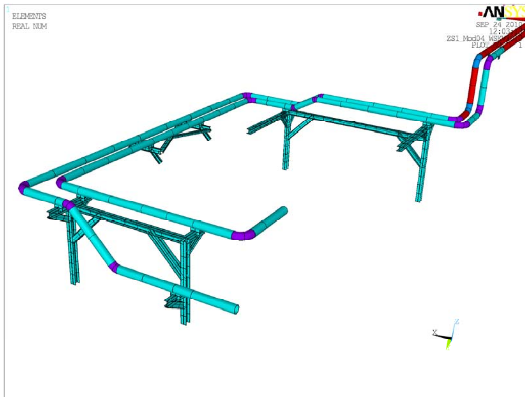
Abbildung 13: Endgültige Modifikation der Rohrleitungsstützen.
