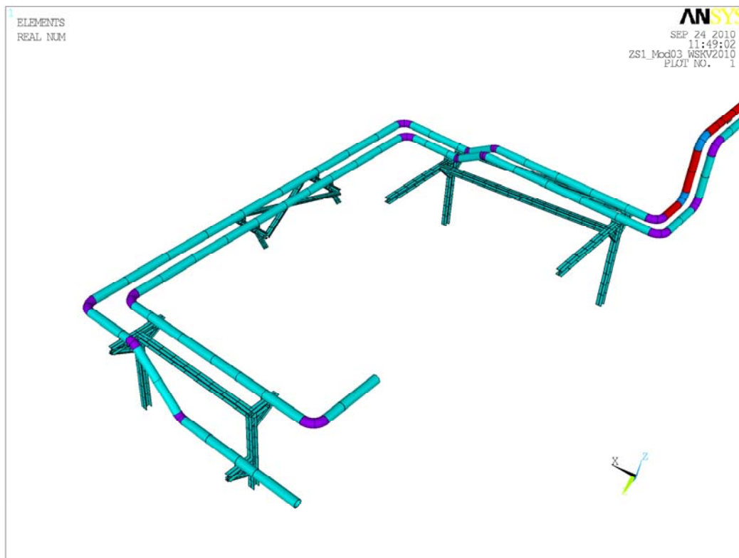
Abbildung 12: Zweite Modifikation der Rohrleitungsstützen.
