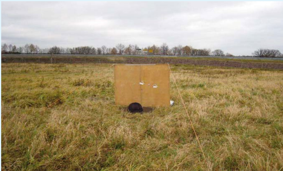
Abbildung 1: Aufbau der abschirmenden senkrechten Platte hinter der waagrechten Platte mit Mikrofon, im Hintergrund Zubringer und Autobahn
