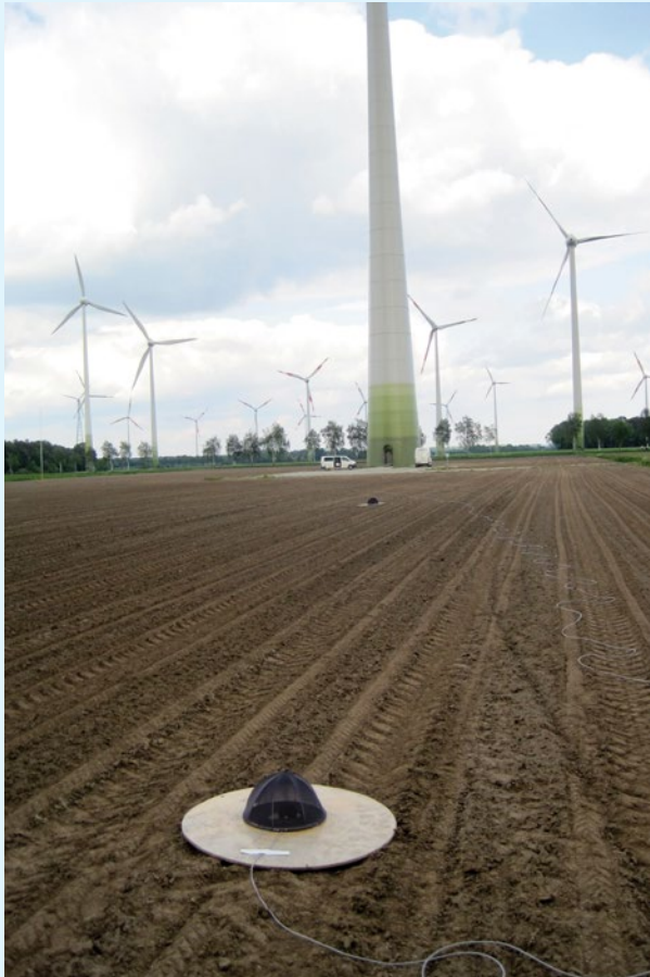
Abbildung 2: Messaufbau mit zwei Mikrofonanordnungen auf schallharten Platten. Im Vordergrund Abstand bei 100%, dahinter liegend Abstand 80%
