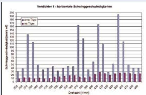
▲ Abbildung 2: Vergleich der eff. Schwinggeschwindigkeiten vor und nach der Tilgerinstallation
