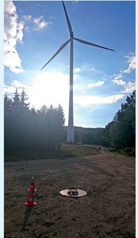
Abb. 2: FGW-konforme Emissionsmessung auf einer Zuwegung an einem Waldstandort
