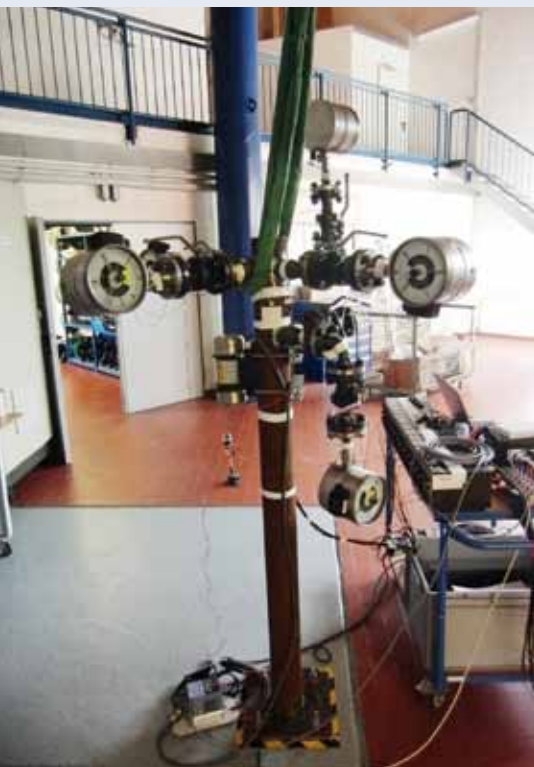
▲ Abbildung 1: Modellleitung für die Aufnahme von Druckmessgeräten
