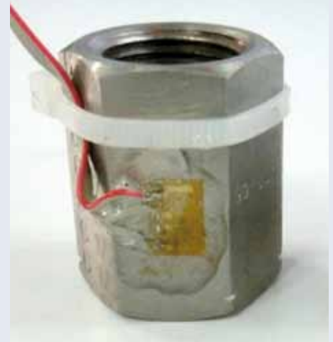
▲ Abbildung 2: Spannmuffe mit Dehnungsmessstreifen
