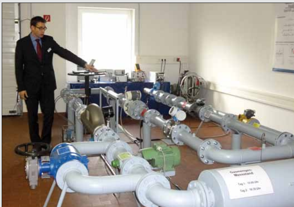
▲ Abbildung 1: Dr.-Ing. Christian Jansen erläutert den Teilnehmern den Versuchsstand Gasmengenmessung
