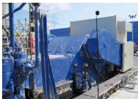
▲ Abbildung 1: Spülpumpenaggregat mit eingehauster Antriebsmotoreinheit
