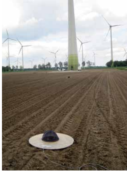
▲ Abbildung 2: Messaufbau mit zwei Mikrofonanordnungen auf schallharten Platten. Im Vordergrund Abstand bei 100%, dahinter liegend Abstand 80%
