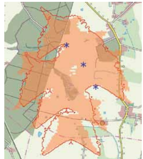
▲ Abbildung: Beispielhafte Schattenwurfaustrahlung von sechs WEA (blau = Vorbelastung, rot = Zusatzbelastung) mit Darstellung der Grenzwerte 30 h/a (Raster) und 30 Minuten/Tag (Linie)
