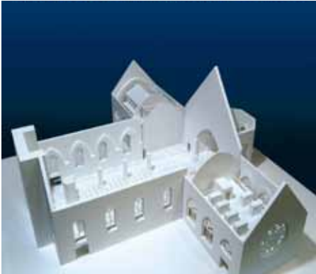
▲ Abbildung 1: Modell der Kirche nach dem Umbau mit abgetrennten Querschiffen
