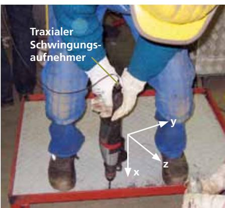
▲ *Abbildung 2: Messung der Hand-Arm-Vibrationen bei einer beidhändigen Bohrtätigkeit mit einer Handbohrmaschine*
