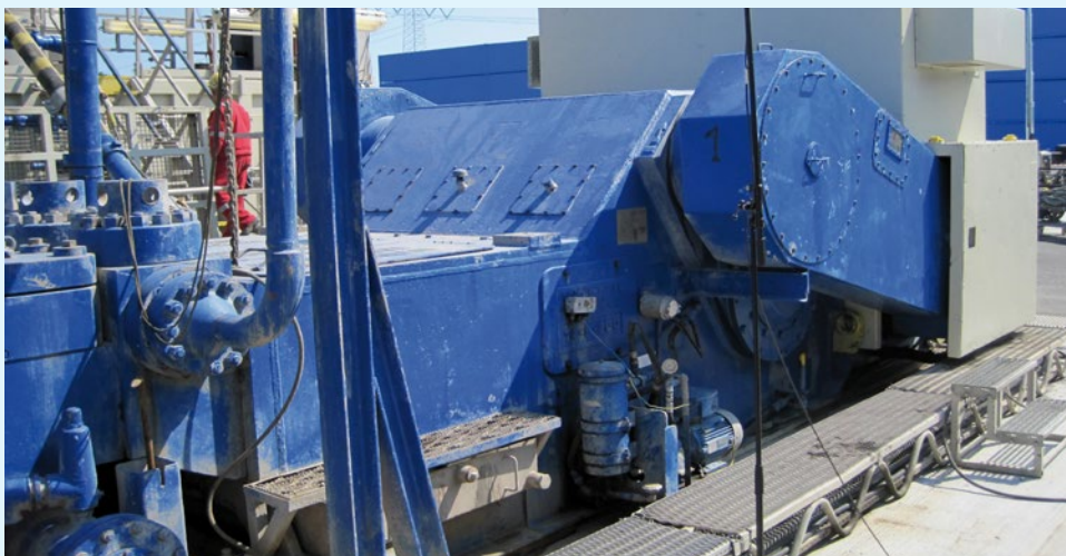
Abbildung 1: Spülpumpenaggregat mit eingehauster Antriebsmotoreinheit
