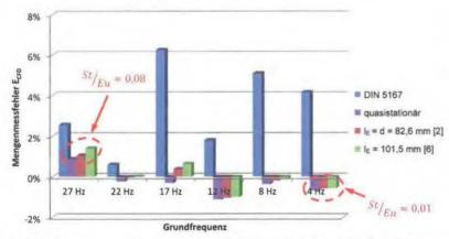
Bild 9. Ausgewertete Mengenmessfehler E<sub>CFD</sub> der instationären CFD-Simulationen bei stationärer (DIN 5167) und instationärer Durchsatzbestimmung.
