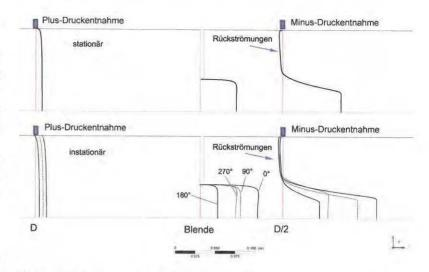
Bild 10. Qualitative Darstellung der simulierten, stationären und instationären Strömungsprofile im Blendenquerschnitt sowie den Druckentnahmeebenen (f = 17 Hz).
