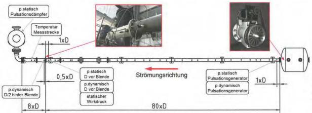
Bild 6. Versuchsaufbau zur messtechnischen Untersuchung der instationären Blendenströmung.
