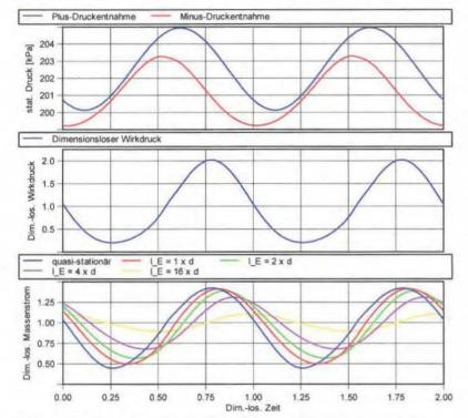
Bild 8. Simulierte Druckverläufe an den virtuellen Druckentnahmestellen der Blende sowie dimensionsloser Wirkdruck π(τ) und dimensionsloser Massenstrom δ(τ) über der dimensionslosen Zeit (τ) für unterschiedliche Ersatzlängen  $I_E$  (f = 17 Hz).
