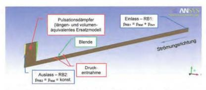
Bild 7. Kreissegmentmodell der Messstrecke sowie verwendete Randbedingungen (RB).
