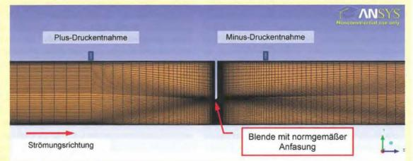
Bild 5.Strukturiertes Netz des Kreissegmentes im Nahbereich der Blende.
