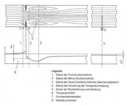
Bild 1. Qualitativer Verlauf einer stationären Blendenströmung mit dazugehörigem Druckverlauf nach (1).
