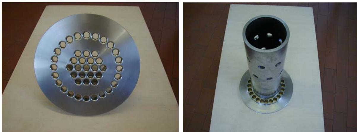
Bild 9: Lösungsvorschlag Pulsations-Dämpferplatten mit Quermodenbrecher.
