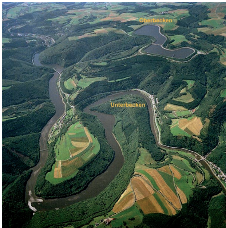
Abb. 1: Luftaufnahme des geteilten Oberbeckens sowie des Unterbeckens bzw. des aufgestauten Flußverlaufes (Our) in Vianden (Luxemburg).
