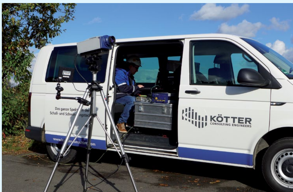
Der Laser zeichnet Schwingungen über eine Distanz von bis zu 400 Metern präzise auf und ist auch bei hohen Temperaturen, in ex-geschützten Bereichen oder bei sehr großen oder kleinen Messobjekten einsetzbar
