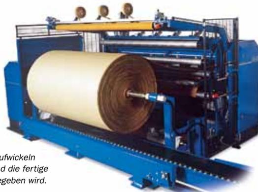
Der Wickelautomat arbeitet mit zwei Wellen auf einem Wendewickler. Das Aufwickeln der neuen Rolle beginnt sofort, während die fertige Rolle geschnitten, versiegelt und ausgegeben wird.
