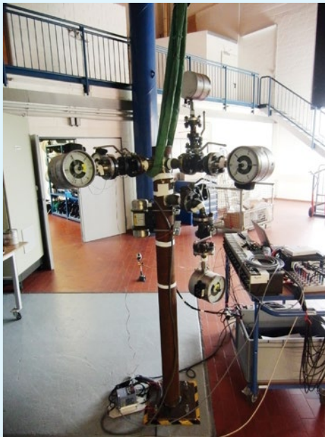
Abbildung 1: Modellleitung für die Aufnahme von Druckmessgeräten
