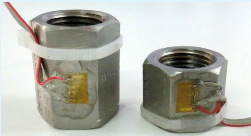
Abbildung 2: Spannmuffe mit Dehnungsmesstreifen
