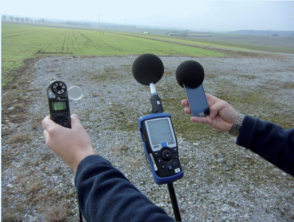
Versuchsaufbau im Freifeld mit geeichtem Pegelmesser XL2-TA und Smartphone Samsung Galaxy S4, beide mit primären Windschirm, sowie Klimagerät
