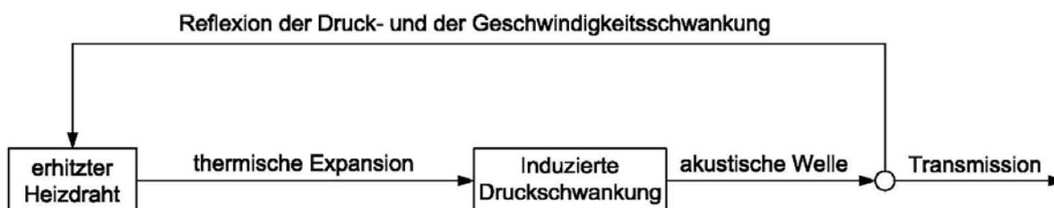
Abbildung 14: Prinzipielle Darstellung der Rückkopplung einer thermoakustischen Instabilität.
