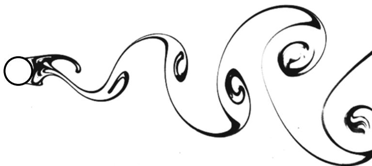
Abbildung 2: Periodische Wirbelablösungen hinter einem kreisrunden Störkörper [2].
