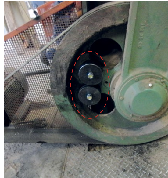
Abb. 2: Abgestimmte Gegengewichte am Schwungrad der Presse
