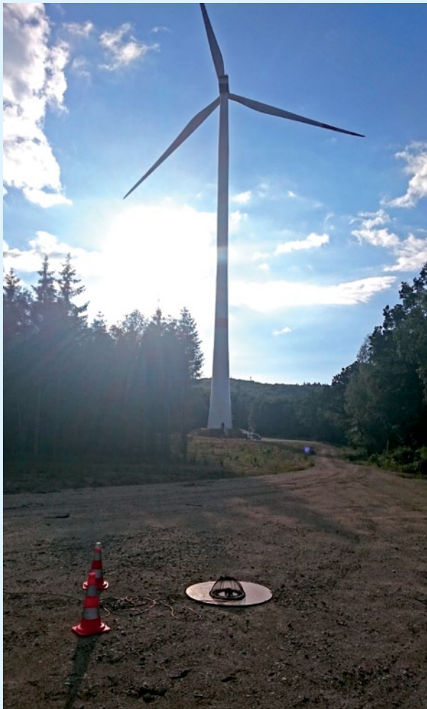
FGW-konforme Emissionsmessung auf einer Zuwegung an einem Waldstandort
