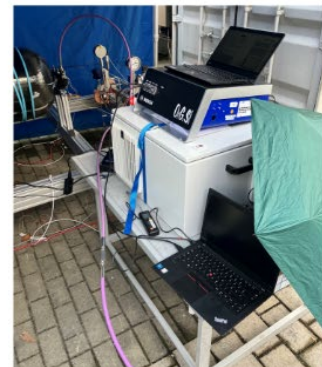
Integration vom Durchfluss-OGS ins Testfeld
