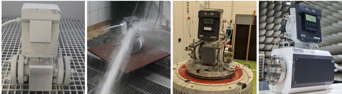
Abbildung 2 Bauartprüfungen hinsichtlich Umwelteinflüsse
